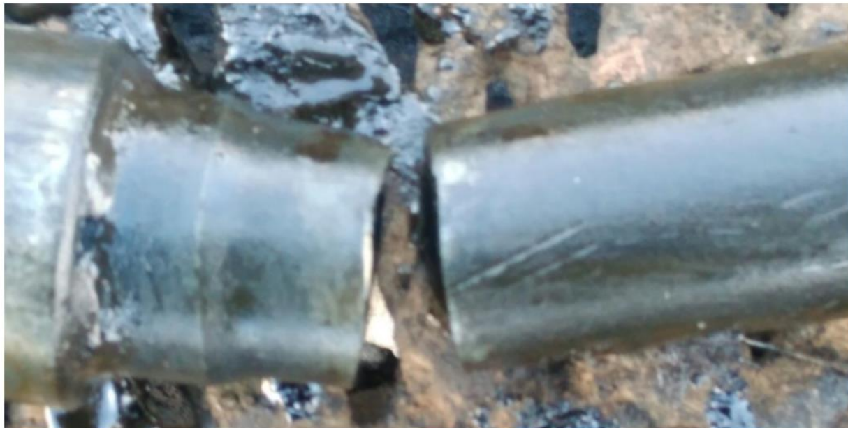
Рисунок 2.2.4 - Хрупкий излом полой насосной штанги
